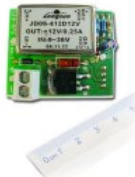
IS1224 izolowane zasilanie DC
